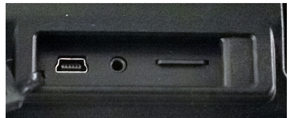
USB-Stromanschluss Videoausgang MicroSD-Kartensteckplatz
