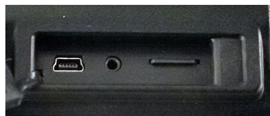
Connexion alimentation USB Port sortie vidéo Fente pour carte micro SD
