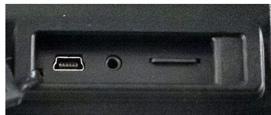
Connessione alimentazione USB Porta di uscita video Slot per scheda micro SD
