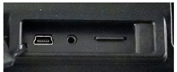
Conexión de alimentación USB Puerto de salida de video Ranura para la tarjeta Micro SD
